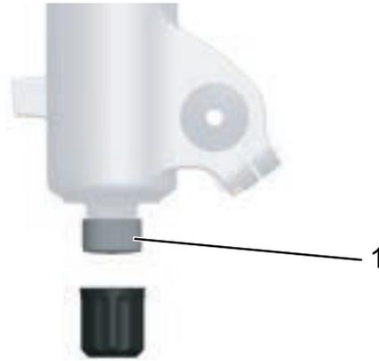
Illustration 53 : Dispositif de réglage de la détente FOX (1) sur la fourche
