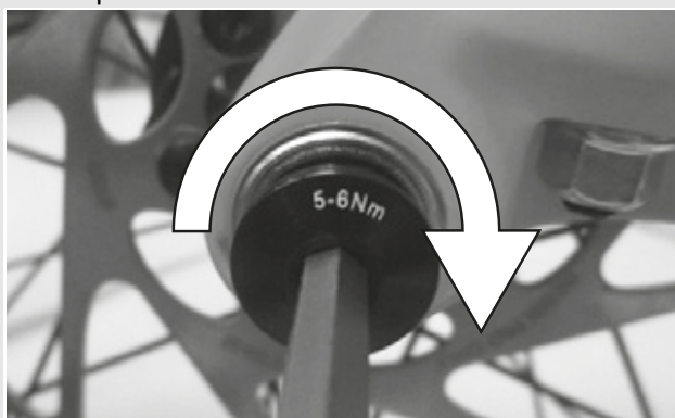
Figura 27: Apriete del tornillo de seguridad
