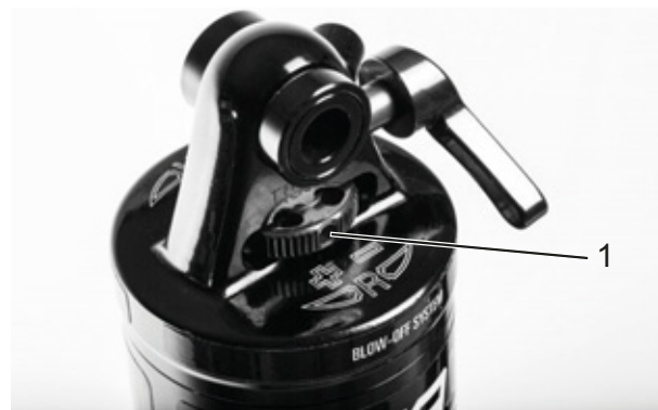
Figura 55: Rueda del regulador de niveles de tracción Suntour (1) en el amortiguador de la horquilla trasera
