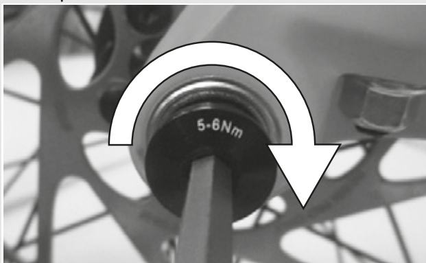
Figura 23: Apriete del tornillo de seguridad
