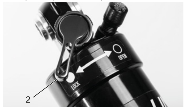
Figura 66: Regulador de niveles de presión Suntour cerrado (2)
