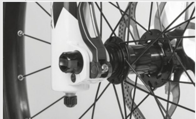
Figura 72: Ajuste de la fuerza de tensado del cierre rápido
