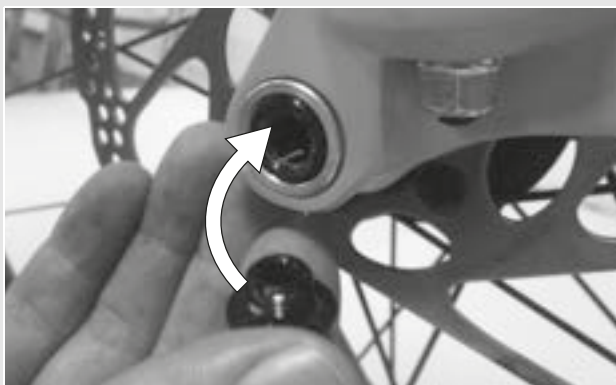
Figura 22: Inserción de la palanca de cierre rápido en el eje
