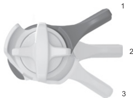
Figura 62: Regulador de niveles de presión FOX en el amortiguador de la horquilla trasera con las posiciones ABIERTO (1), MEDIO (2) y DURO (3)
