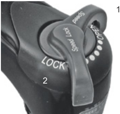
Figura 64: Regulador de niveles de presión Suntour con las posiciones OPEN (1) y LOCK (2)
