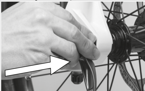
Figura 33: Inserción del cierre rápido
