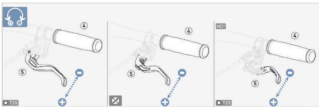
Figura 224: Reglarea lățimii de prindere a frânei de mână la frâna cu disc MAGURA
