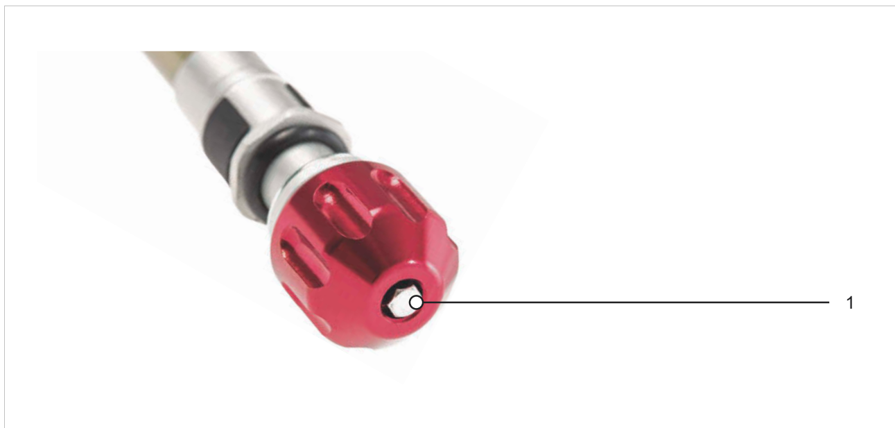
Figura 251: Exemplu dispozitiv de reglare a revenirii SR SUNTOUR (furcă cu suspensie) (1)
