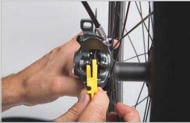
Figura 366: Verificați plăcuța de frână în stare montată, cu ajutorul siguranței la transport
