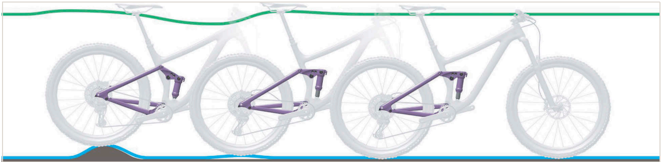
Figura 508: Revenire prea rapidă a amortizorului spate
