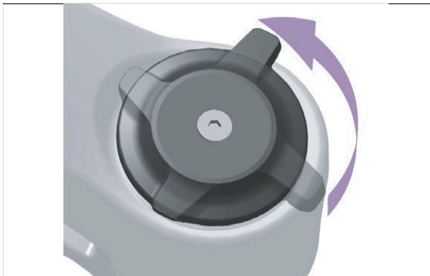
Figura 481: Reglarea mai moale a dispozitivului de reglare a compresiei
