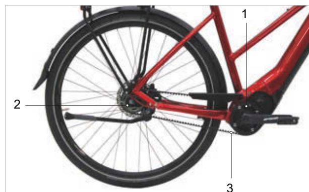
Figura 74: Schema transmisiei cu curea
