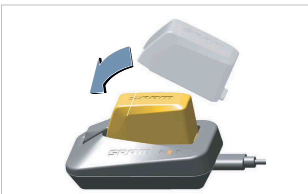
Figura 526: Montarea capacului bateriei
