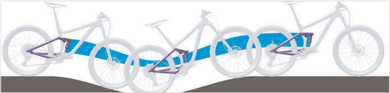
Figura 496: Suspensie prea moale a amortizorului spate la munte
