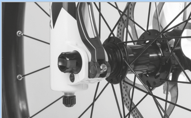
Figura 395: Reglarea forței de strângere a dispozitivului de eliberare rapidă
