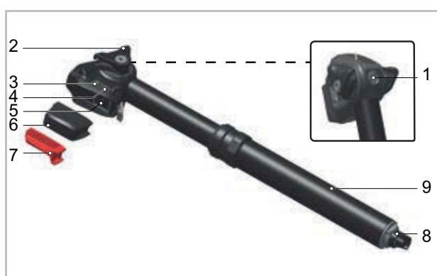
Figura 70: Structura tijei de șa ROCKSHOX, Reverb AXS
