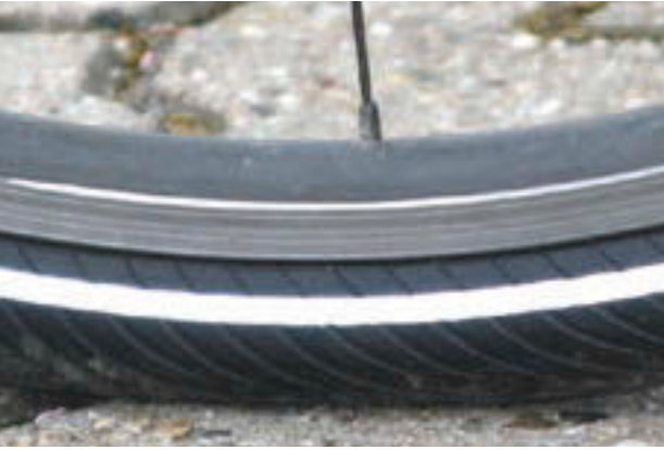
Figura 216: Presiunea de umflare corectă. Anvelopa abia se deformează sub sarcina greutății corpului
