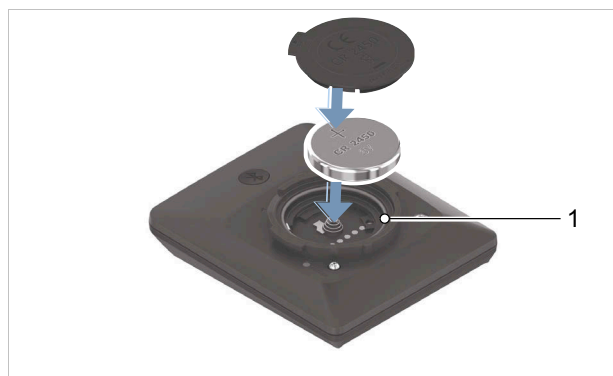
Figura 267: Introduceți bateria cu garnitura de cauciuc corect aliniată (1)
