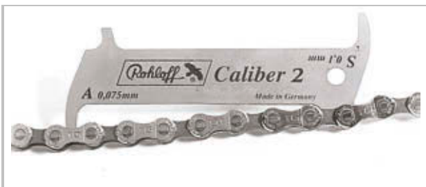
Figura 372: Exemplet de lera de măsurat ROHLOFF
