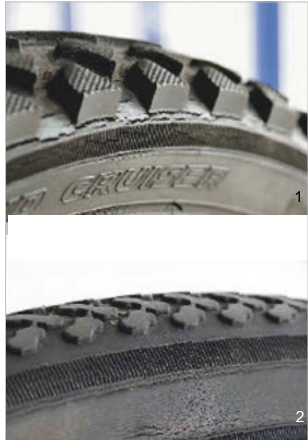
Figura 365: Exemple de fisuri de oboseală (1) și fisuri de îmbătrânire (2)
