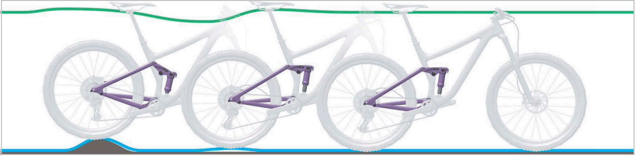
Figura 492: Revenire prea rapidă a amortizorului spate
