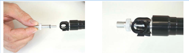
Figura 415: Înșurubarea adaptorului supapei
