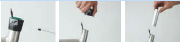
Figura 406: Demontarea manșonului exterior și a bucșei de alunecare
