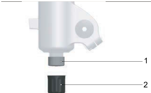
Figura 483: Dispozitiv de reglare a reveniri FOX (furcă) (1) sub capacul furcii (2)
