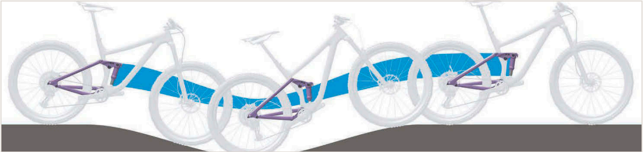
Figura 512: Suspensie prea moale a amortizorului spate la munte
