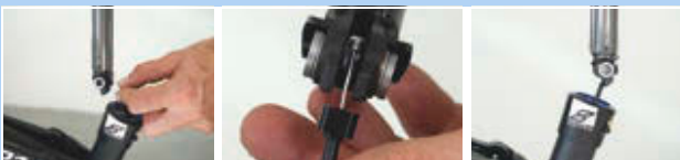
Figura 456: Prinderea și introducerea tije de șa
