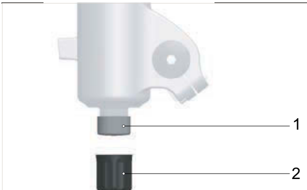
Figura 485: Dispozitiv de reglare a reveniri FOX (furcă) (1) sub capacul furcii (2)
