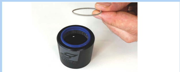
Figura 442: Șaibă elastică îndepărtată
