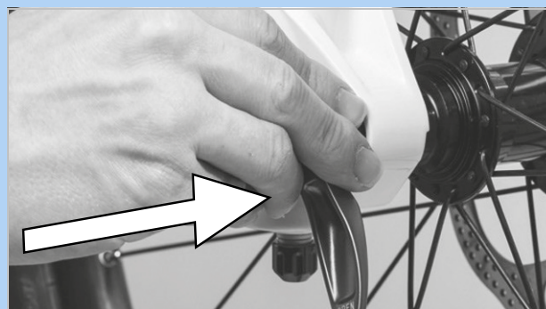
Figura 183: Împingerea dispozitivului de eliberare rapidă în direcția săgeții
