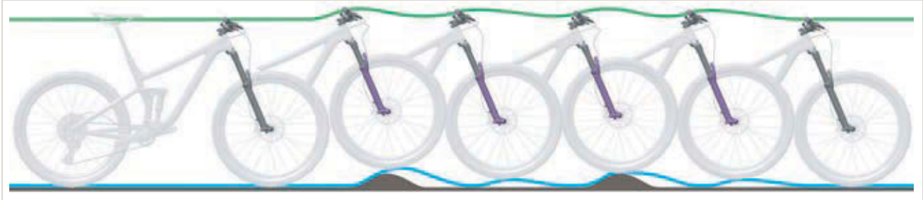
Figura 482: Revenire prea rapidă a furcii cu suspensie
