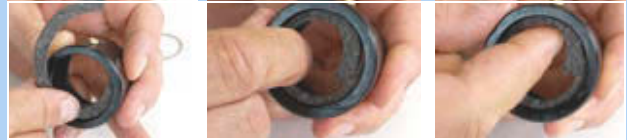
Figura 446: Introducerea inelului de pâslă
