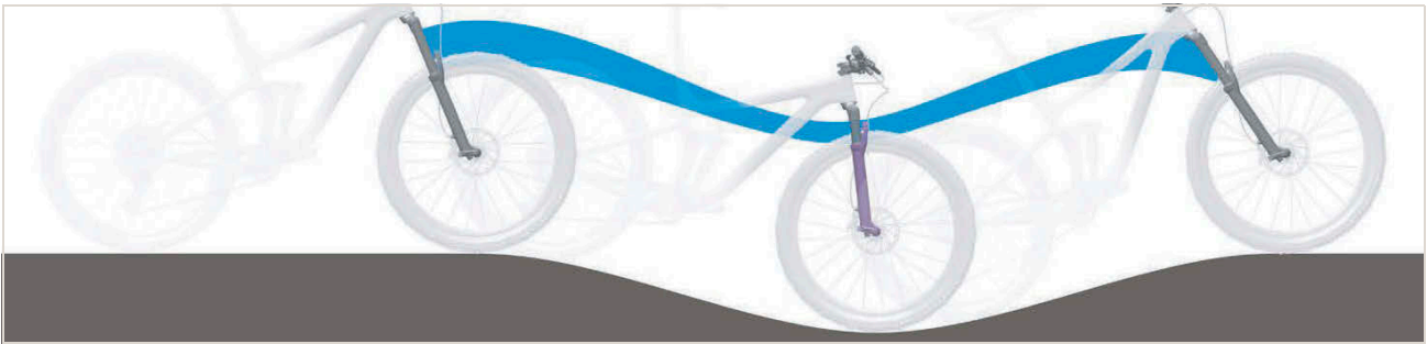
Figura 486: Furcă cu suspensie prea moale pe munte
