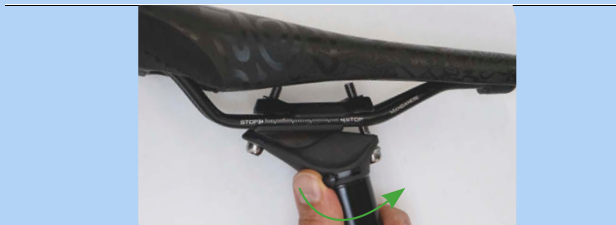
Figura 449: Deschiderea reglării înălțimii
