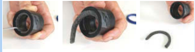
Figura 409: Îndepărtarea inelului de pâslă
