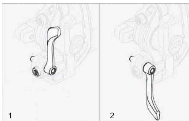
Figura 55: Manetă de blocare a frânei pe jantă închisă (1) și deschisă (2)
