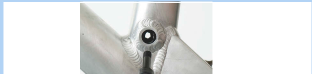
Figura 427: Fixarea capacului supapei la cartuș
