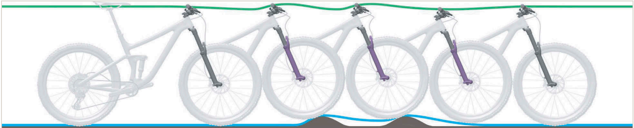
Figura 484: Revenire prea lentă a furcii cu suspensie
