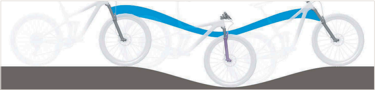
Figura 478: Suspensie prea moale a suspensiei furcii cu suspensie la munte
