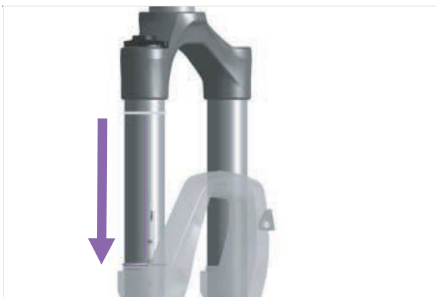
Figura 237: Deplasați garnitura inelară pe furca cu suspensie
