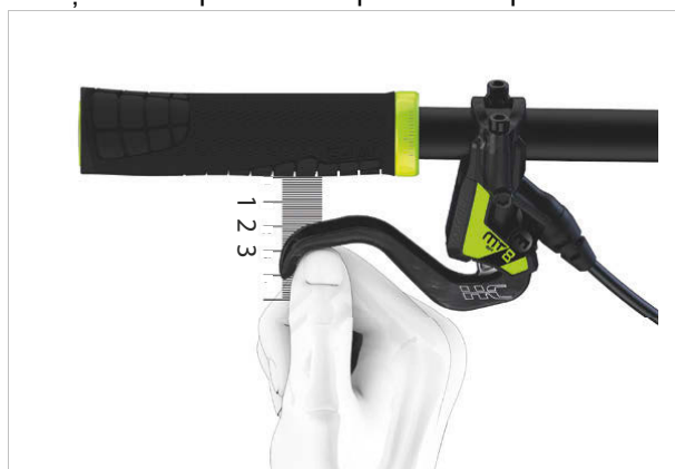
Figura 221: Poziționarea frânei de mână
