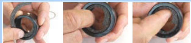
Figura 411: Introducerea inelului de pâslă
