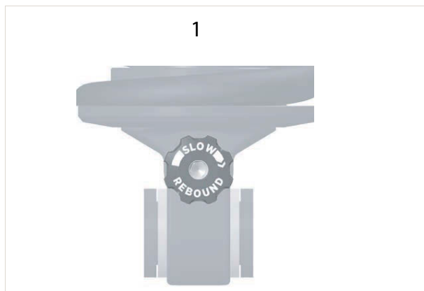
Figura 257: Dispozitiv de reglare a revenirii Floator DHX (1)
