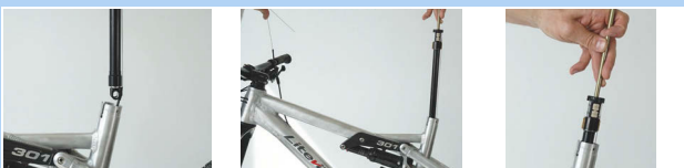
Figura 426: Fixarea capacului supapei la cartuș
