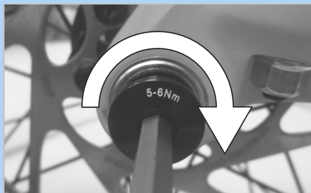
Figura 175: Strângerea șurubului de blocare
