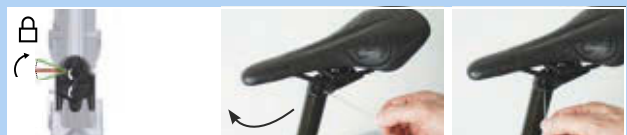
Figura 435: Închiderea reglării înălțimii
