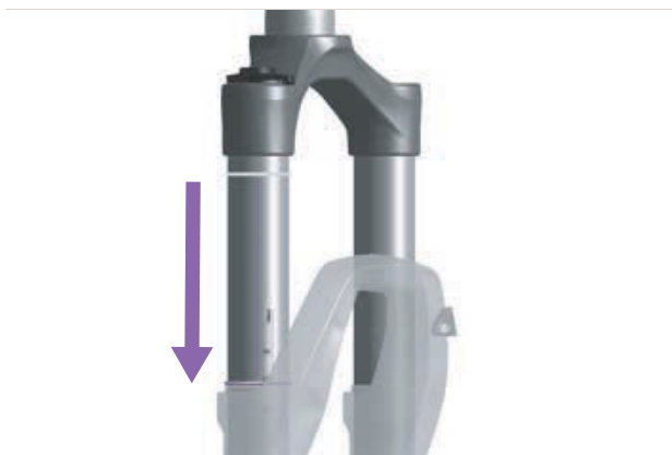
Figura 234: Deplasați garnitura inelară a furcii cu suspensie
