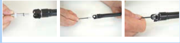
Figura 421: Fixarea capacului supapei la cartuș
