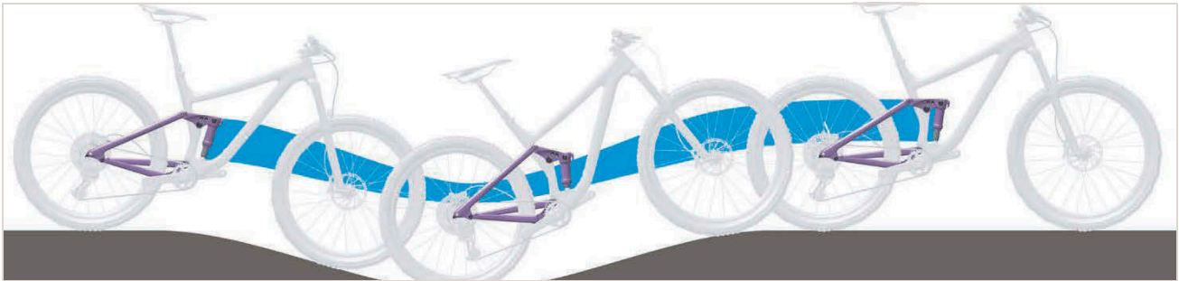
Figura 504: Suspensie prea moale a amortizorului spate la munte
