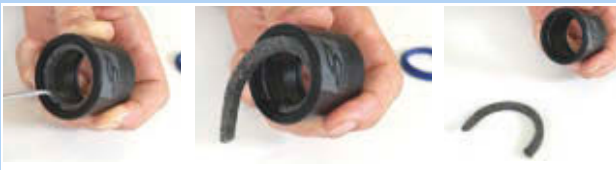
Figura 444: Îndepărtarea inelului de pâslă
