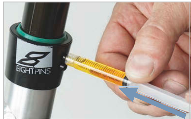
Figura 362: Lubrifierea tijei de șa EIGHTPINS
