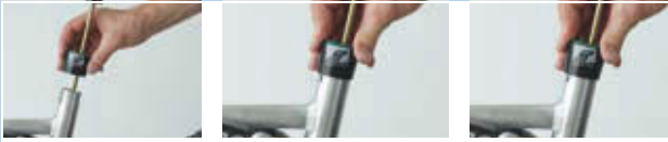
Figura 430: Montarea manșonului exterior
