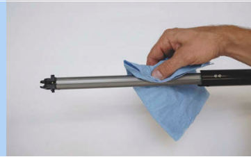
Figura 451: Curățarea canelurii de ghidare longitudinale
