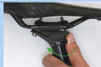
Figura 454: Închiderea reglării înălțimii
