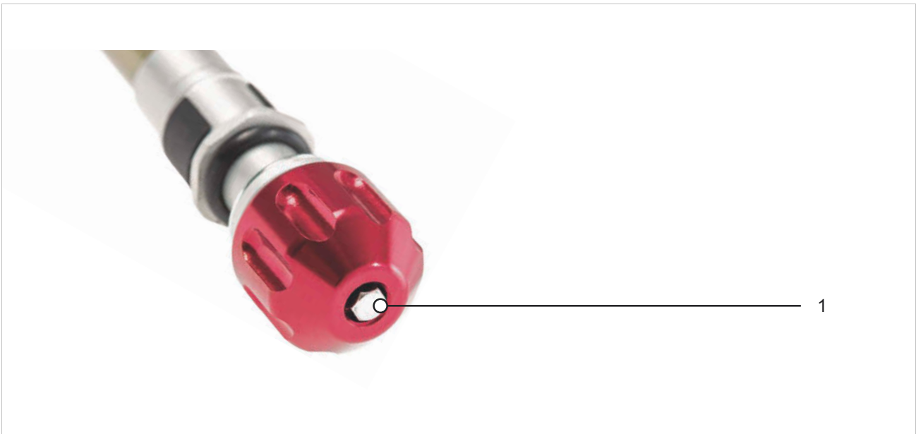
Figura 471: Exemplu dispozitiv de reglare a revenirii SR SUNTOUR (furcă cu suspensie) (1)
