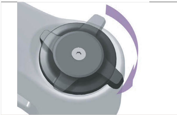
Figura 479: Reglarea mai dură a dispozitivului de reglare a compresiei
