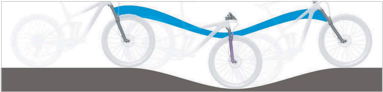
Figura 472: Suspensie prea moale a suspensiei furcii cu suspensie la munte
