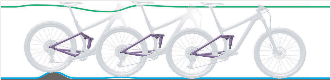
Figura 500: Revenire prea rapidă a amortizorului spate
