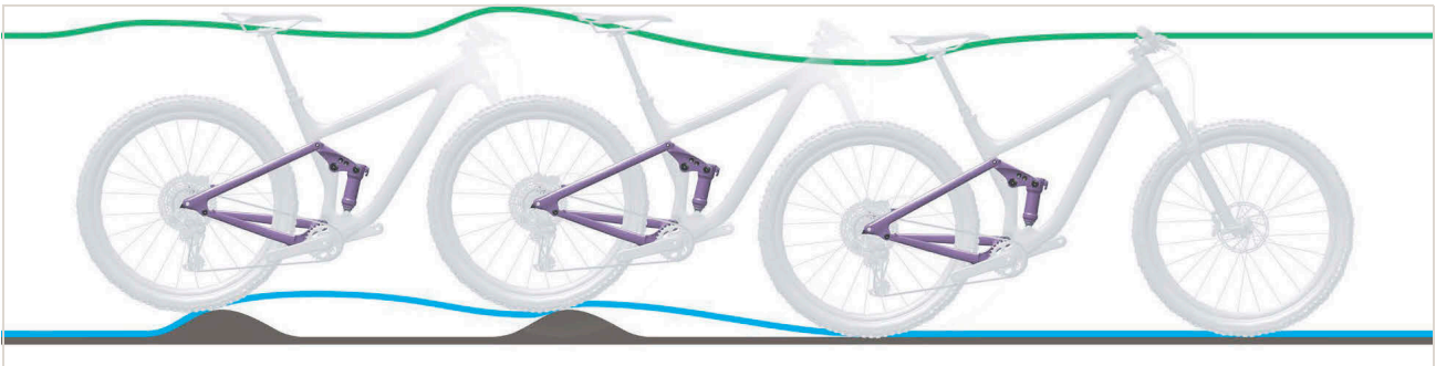
Figura 494: Revenire prea lentă a amortizorului spate
