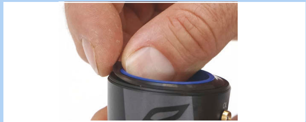
Figura 441: Scoaterea inelului cu buză de etanșare
