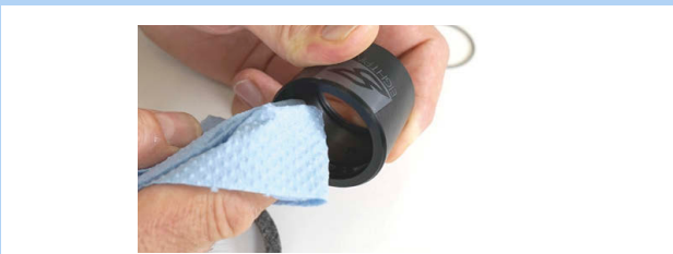
Figura 445: Curățarea manșonului exterior
