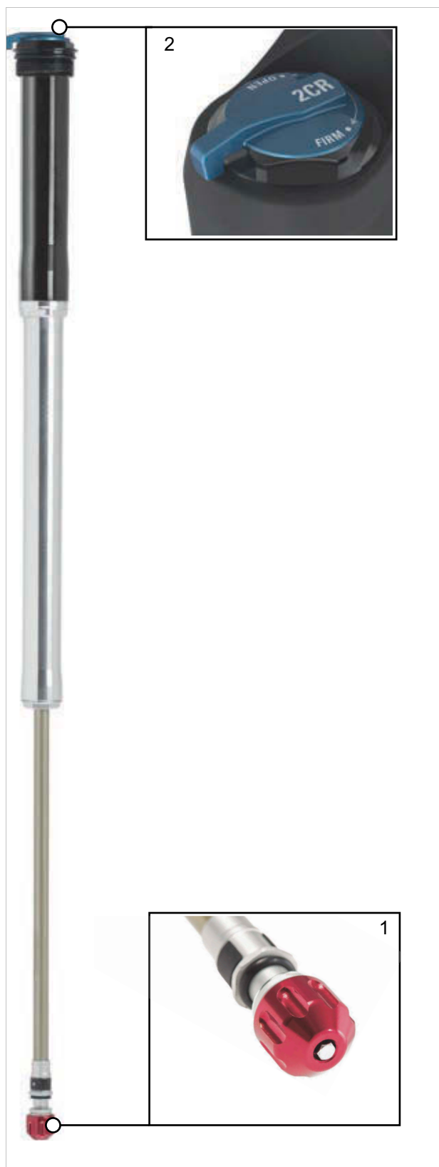
Figura 31: Elemente de operare ale 2CR-PCS
