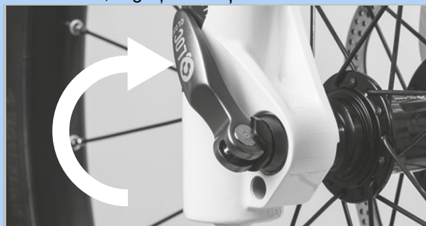
Figura 185: Închiderea dispozitivului de eliberare rapidă
