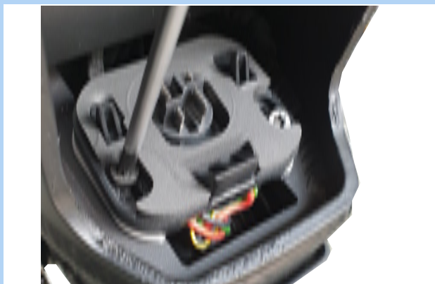
Obr. 47: Povolení šroubů držáku akumulátoru
