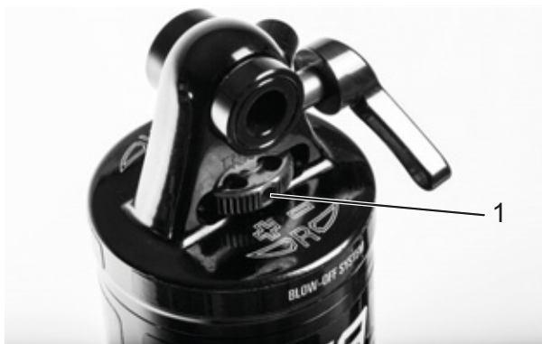
Obr. 101: Nastavovací šroub odskoku Suntour (1) na tlumiči zadního odpružení
