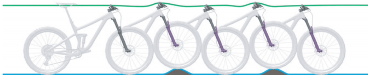
Obr. 11: Optimální chování vidlice při jízdě
