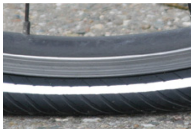
Obr. 88: Příliš nízký tlak
