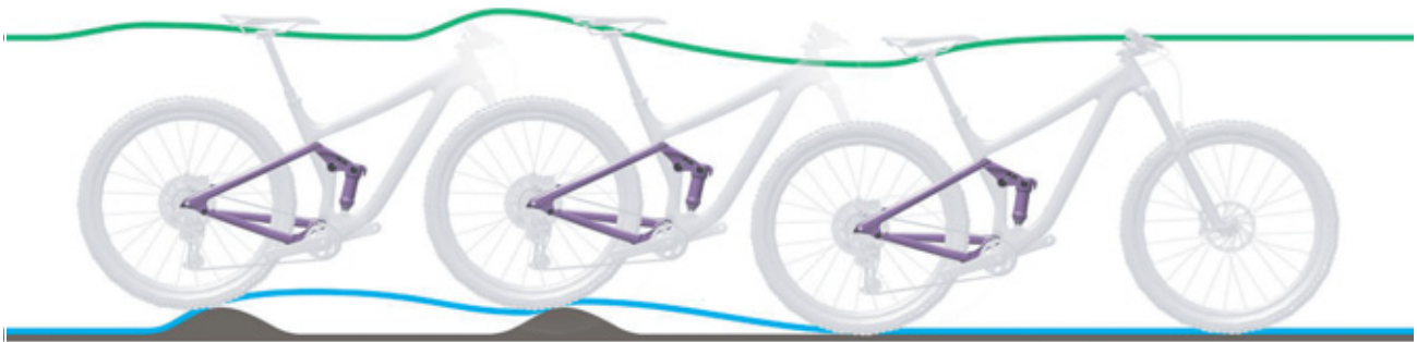
Obr. 219: Příliš pomalé roztahování tlumiče zadního odpružení
