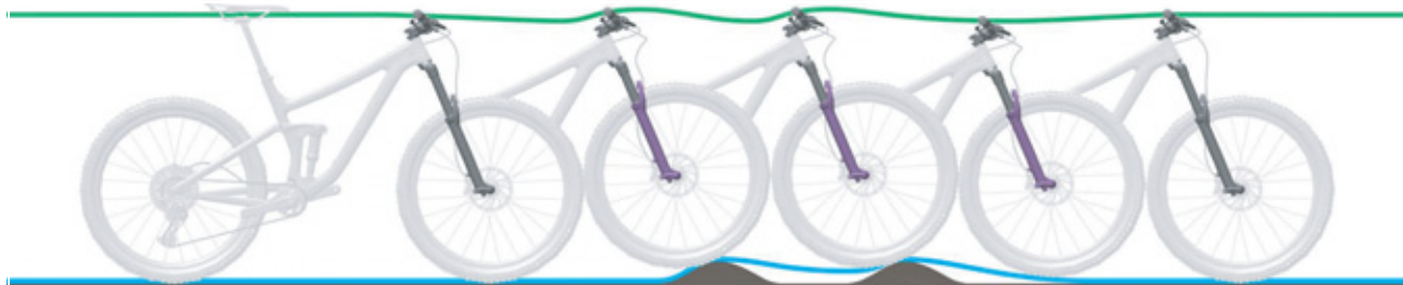
Obr. 211: Příliš pomalé roztahování odpružené vidlice
