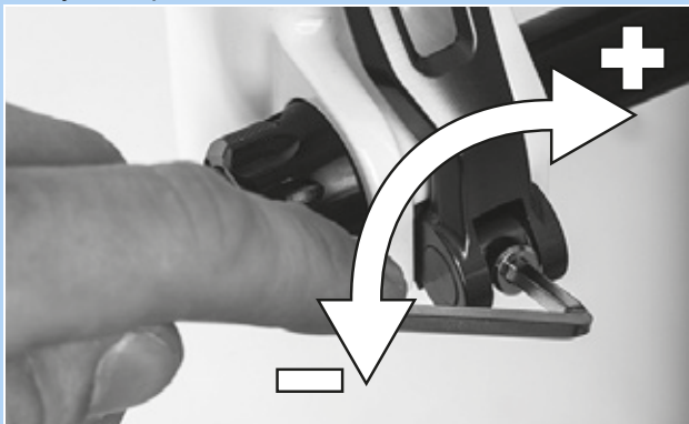
Obr. 145: Nastavení upínací síly rychloupínáku
