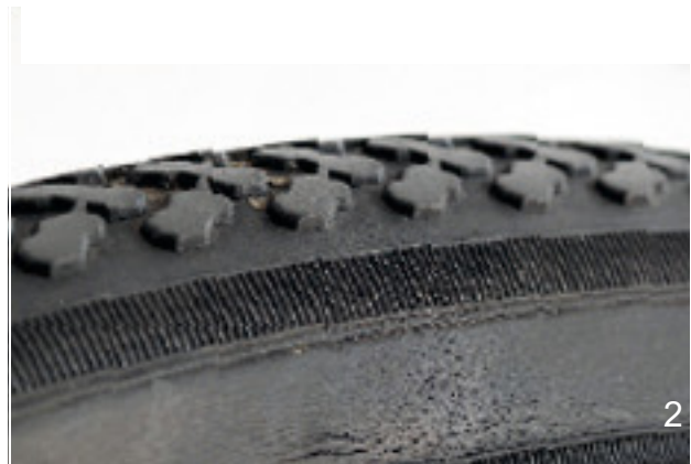
Obr. 135: Příklady únavových trhlin (1) a trhlin vzniklých stárnutím (2)
