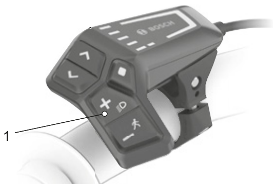
Obr. 122: Umístění tlačítka osvětlení (1)
