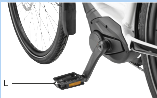
Obr. 67: Pedál L levého ramena kliky
