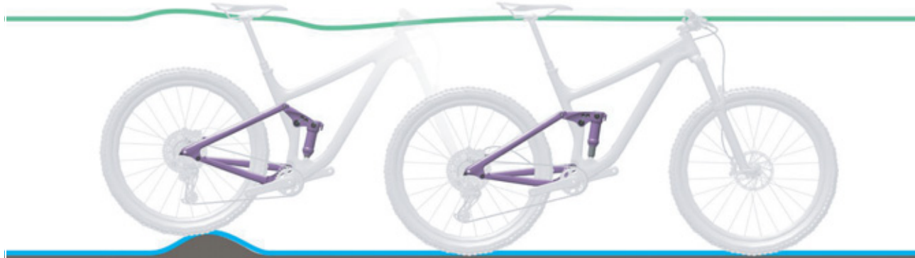
Obr. 102: Optimální chování tlumiče zadního odpružení při jízdě u nerovností
