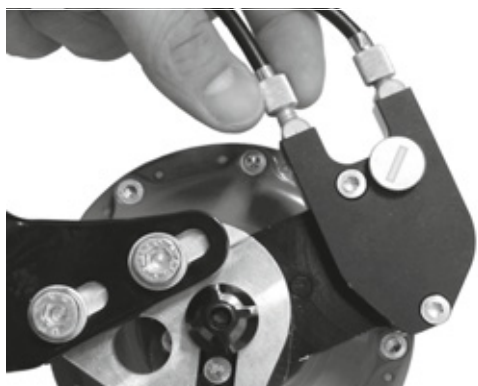
Obr. 140: Náboje Rohloff s externím ovládním řazení mají seřizovače napnutí na lanovodu, který je umístěn na levé straně
