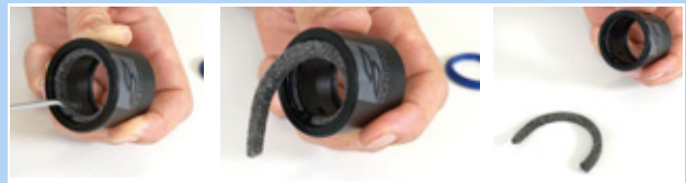
158. ábra: A filcgyűrű eltávolítása
