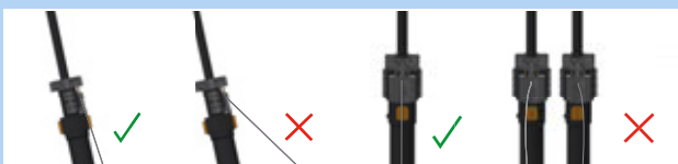
174. ábra: Helyesen és hibásan beállított bovdent
