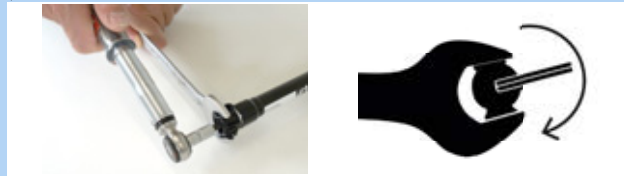
169. ábra: Beállítás az óramutató járásának irányában
