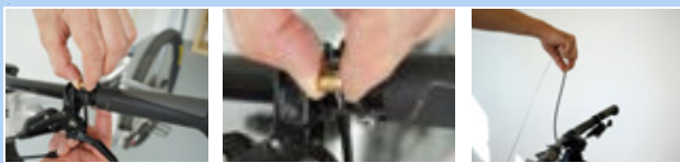
186. ábra: Távirányító oldása
