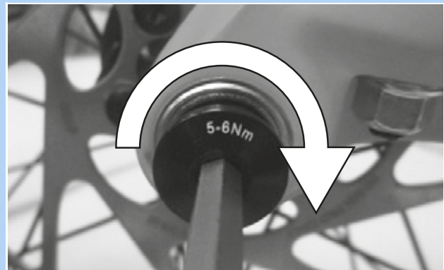
56. ábra: A rögzítőcsavar meghúzása
