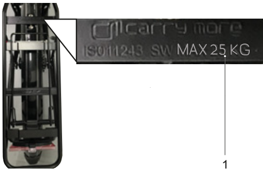
115. ábra: A csomagtartón fel van tüntetve maximális teherbírása (1)
