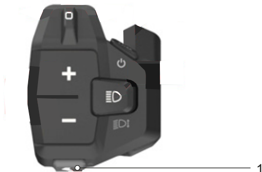
119. ábra: A tolási rásegítés gomb elhelyezkedése
