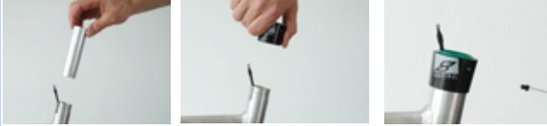
204. ábra: Siklóperselyy és külső hüvely beépítése
