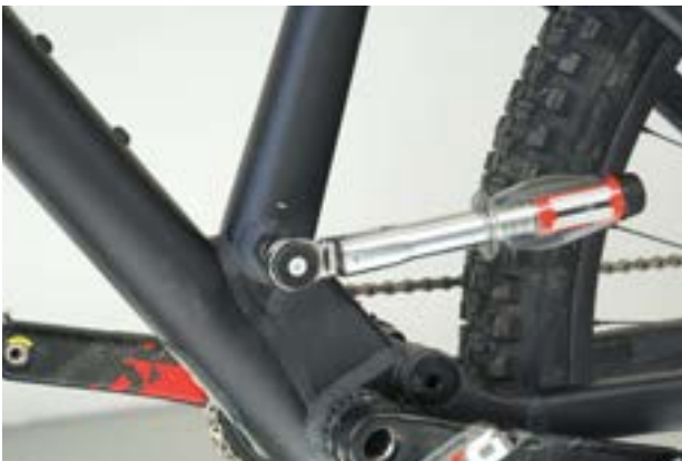
75. ábra: A nyeregcsőtengely meghúzása
