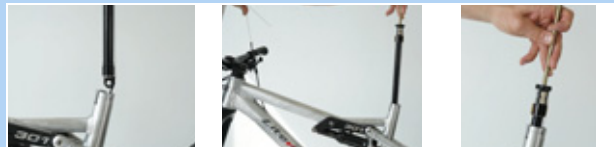
175. ábra: Tubus szelepfedél rögzítése
