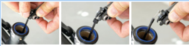
188. ábra: Bovden eltávolítása
