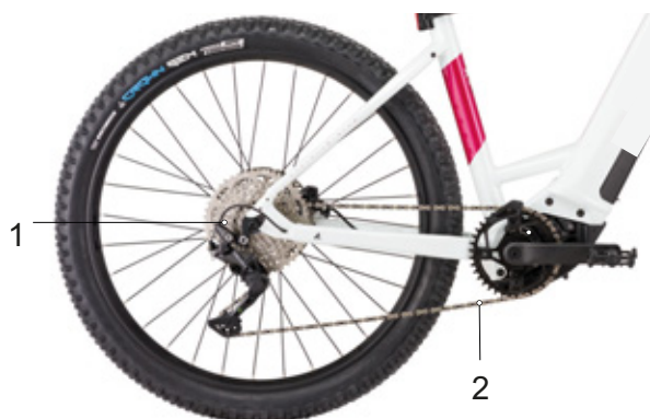
27. ábra: Külső váltóval felszerelt lánchajtás vázlata
