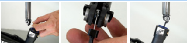
205. ábra: A nyeregcső felakasztása és betolása
