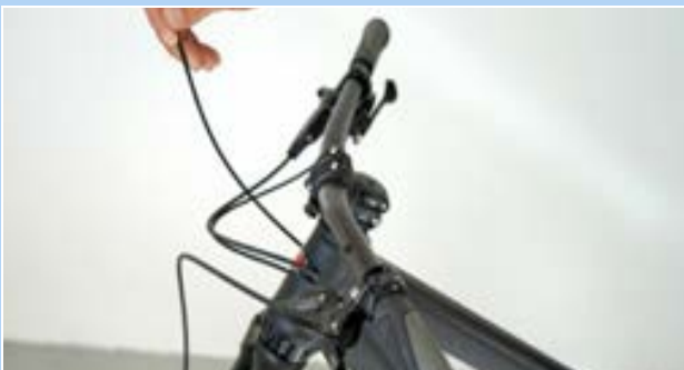
206. ábra: Végsapka beakasztása
