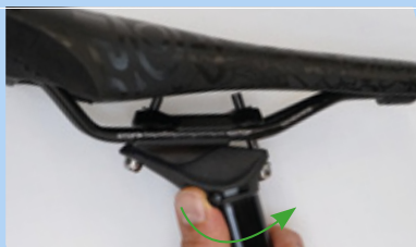
198. ábra: Magasságállítás nyitása
