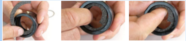
195. ábra: Filcgyűrű behelyezése
