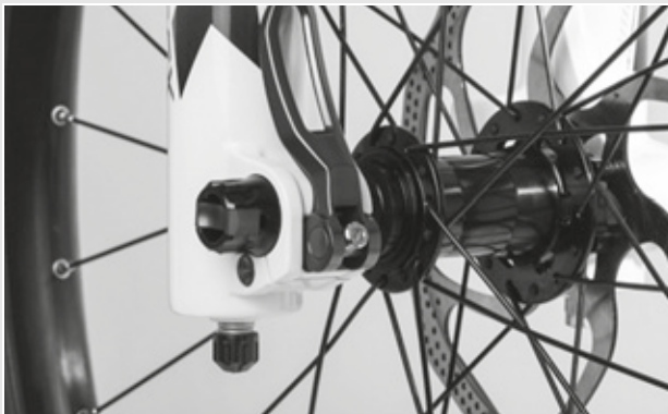
Figura 35: Corretta posizione della leva di serraggio
