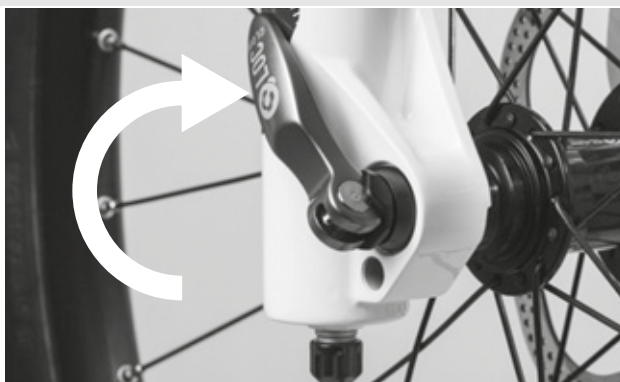
Figura 40: Chiusura del bloccaggio rapido
