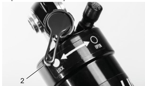
Figura 82: Regolatore della compressione Suntour chiuso (2)
