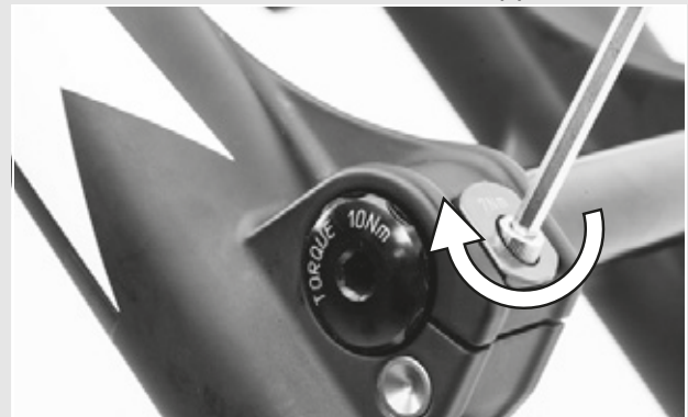
Figura 30: Serraggio del perno
