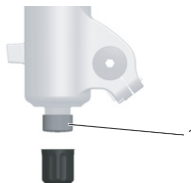
Figura 59: Regolatore del rebound FOX (1) sulla forcella
